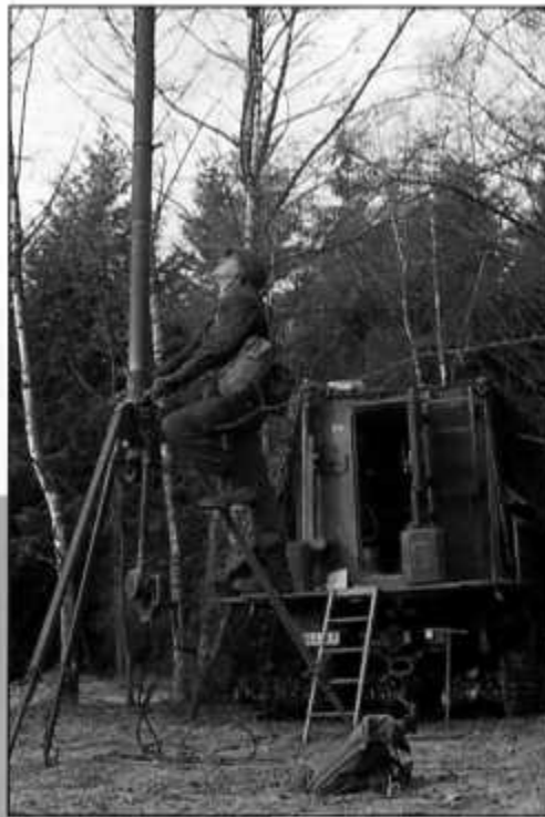
Devant un véhicule radio de type MRC4, une antenne télescopique de 25 m permet de dépasser la crête des arbres
